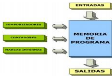
Figura 1 Ciclo de funcionamiento de PLC. Ramírez & Bernal, 2015.
